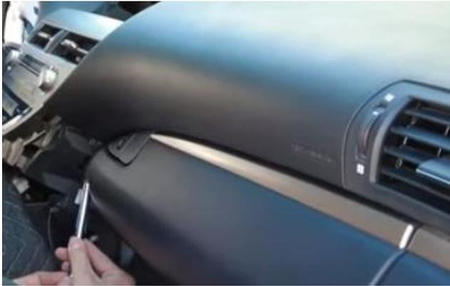
Retirez les deux boulons à droite par la même ouverture.
