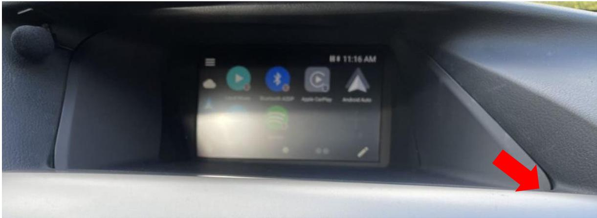
Débranchez la fiche vidéo et connectez-la à la prise du câble vidéo de la Vline. Rebranchez le connecteur vidéo du câble vidéo de la Vline sur l'écran. Dévissez l'écran (3 vis) et placez-le dans un endroit sûr.
