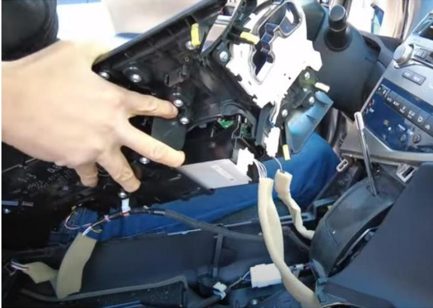
Legen Sie das Panel beiseite oder ziehen Sie den Netzstecker vollständig und stellen Sie es an einen sicheren Ort.
