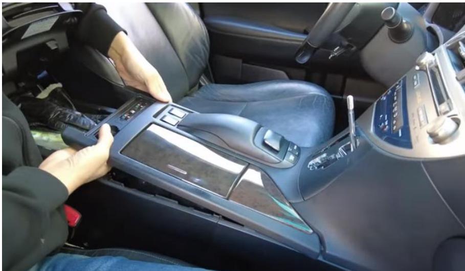
Drehen Sie den Knopf am Schalthebel und ziehen Sie die Mittelkonsole nach oben und ab.
