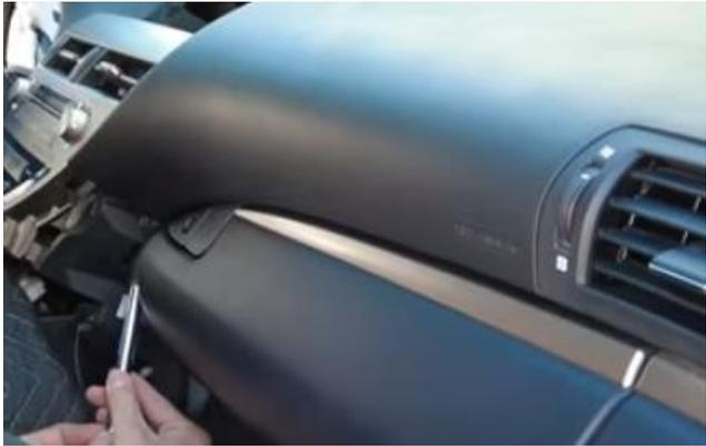
Entferne beide Schrauben auf der rechten Seite durch die gleiche Öffnung.
