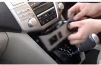
Ziehen Sie die Blende unter dem Radio nach vorne und außen.
