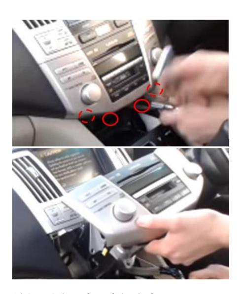
Schritt 4. Display entfernen (Schrauben)
