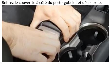
Étape 4. Retirez les deux panneaux de la console centrale (vis)
