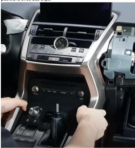
Étape 9. Retirez le pupitre de commande de l'unité de climatisation (déclipsez-le) Tirez la console de climatisation vers l'avant, desserrez-la et débranchez-la. Placez la console dans un endroit sûr.
