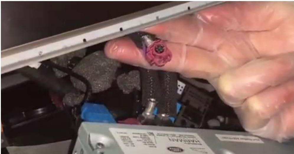
Verbinden Sie den freigegebenen Videostecker mit der Buchse des anderen Videokabels (dies ist nur in 1 Richtung möglich).
