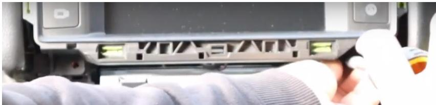
Lösen Sie die Torx-Schrauben des Bedienfelds des Displays und ziehen Sie den Stecker heraus (prüfen Sie sorgfältig, wie sich das Anschlusskabel befindet, da es später ausgetauscht werden kann).
