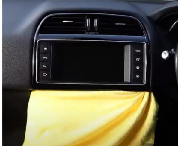
Überprüfen Sie nach dem Entfernen die Lüftungsschlitze in der Verkleidung, sie haben sich möglicherweise damit gelöst. Schieben Sie sie in diesem Fall wieder in Position.
