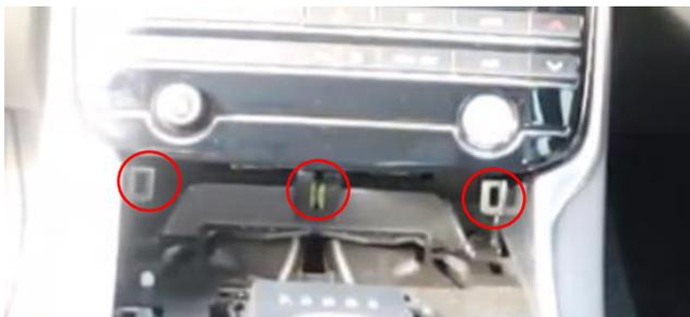
Ziehen Sie die Klimaanlage vollständig ab. Dieser ist sehr eng, aber es sind 6 Clips, er ist nicht verschraubt.
