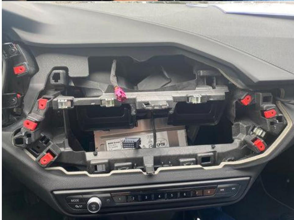
**Étape 4. Retirez le panneau sous l'unité de commande de la radio (déclipsez)**
