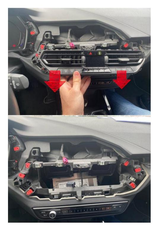
Schritt 4. Entfernen Sie die Verkleidung unter der Steuereinheit vom Radio (ausclipsen)
