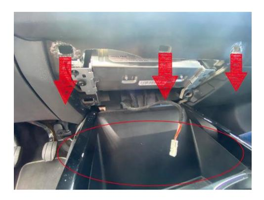
Schritt 5. Entfernen Sie die Haupteinheit (Schrauben)
