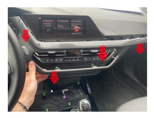
Schritt 2. Entfernen Sie das Display (Schrauben)
